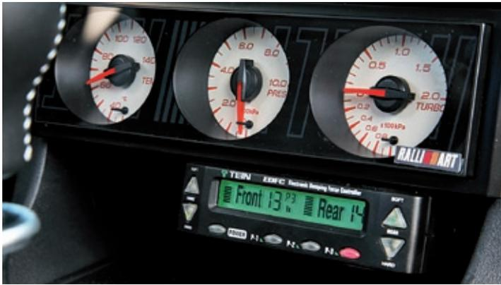
Wie es sich für einen Rallyepionier gehört, montiert Gassner eine Konsole mit Zusatzanzeigen sowie ein Display zur Einstellung der Dämpferhärte
