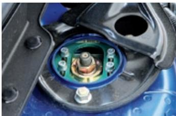
Das elektrisch einstellbare Tein-Fahrwerk überzeugte wenig
