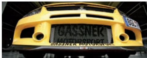
Die Frontschürze ist mit Carbon-Lippe und beschriftetem Ladeluftkühler verziert. Hinter den ATS-Rädern sorgt eine Brembo-Anlage auch nach zehn Runden für perfekte Verzögerung
