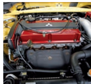
Gassner erreicht 350 PS mit Elektronikänderungen, neuen Ladeluftrohren und HJS-Sportauspuffanlage
