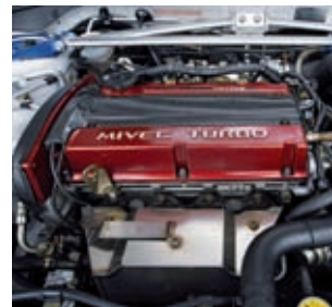
Importtracing optimiert die Kennfelder, verbaut eine stärkere Benzinpumpe und eine Sintermetallkupplung
