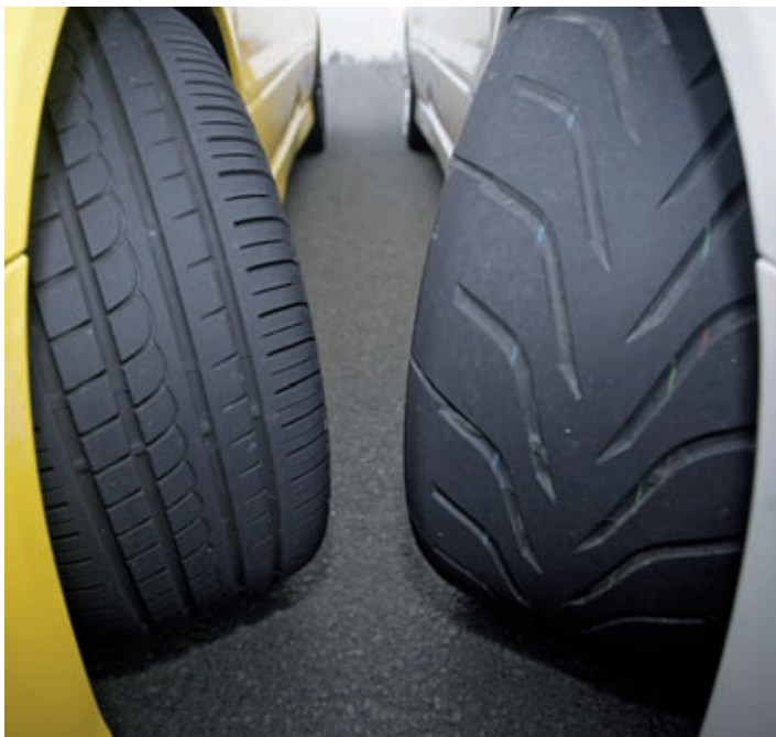
Dank Toyo-Semislicks und breiterer Vorderräder klebt der Importracing-Evo deutlich besser am Asphalt als der Pirelli-bereifte Gassner-Evo
